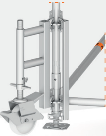
Adaptateur pour roue Transformez facilement votre tour de travail fixe en tour mobile en installant ce composant à la base.
